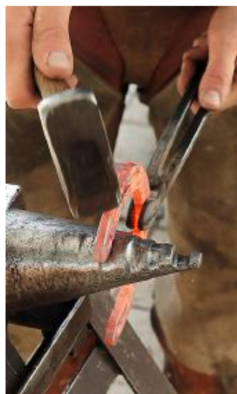
Auf dem Amboss wird das Hufeisen in die richtige Form geschlagen.
